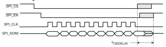
Figure 26. Chip-Select-Active-to-ENA-Signal-Active-Timeout
