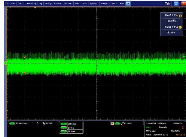
$V_{in}=48V$ ,  $I_o=15A$  /Ripple= $38mV$
